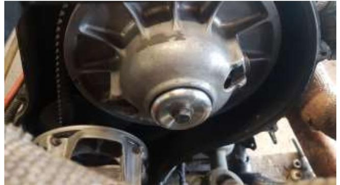
Beim Anziehen der oberen Variomatik die Zentralschraube (15er Ringschlüssel oder Ratsche) mit 65 NM anziehen (original wir blaue Schraubensicherung benutzt)
