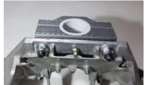
Bei der Montage des Lagerbockes verwende ausreichend wasserbeständiges Fett in der Buchse. Achte darauf, dass die 2 Dichtungen in der vorgesehenen Einfräsung sich befinden und nicht an einer anderen Stelle eingeklemmt oder verdreht sind
