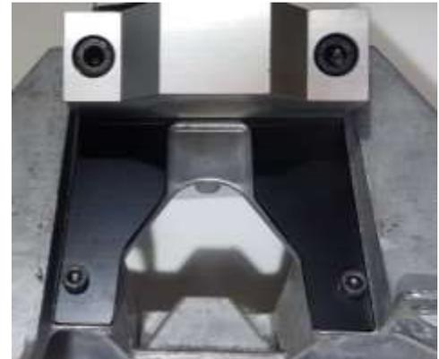
Das Verstärkungsblech hat durch die 4 Fach Verschraubung den Effekt , dass sich der Druck der auf die Verschraubung der Klammer (Lagerbock) auf die 5fache und viel stabilere Fläche verteilt wird, um so vor teuren Sturz-Folgeschäden zu schützen. Um die 2 zusätzlichen 5 mm Löcher zu bohren, musst du die Front Verkleidung und den Luftfilterkasten abnehmen.
