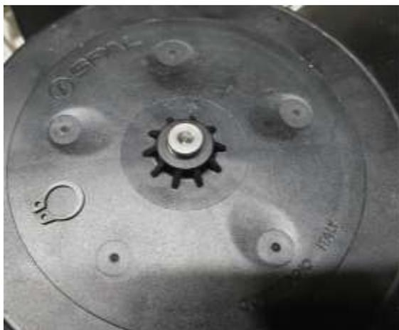
Richte das Lüfter Rad aus und befestige es mit dem Sicherungsring. Achte darauf, dass sich das Lüfter Rad frei und ohne Kontakt dreht.
