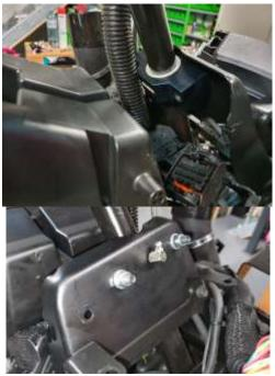
Beim Zusammenbau achte darauf das keine Kabel geklemmt werden und alle Bauteile verspannungsfrei montiert werden.
